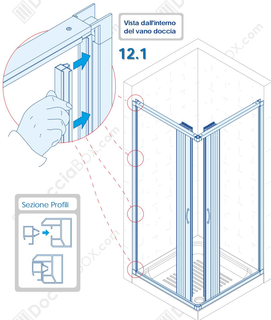
**14** Dall'interno del vano doccia **inserire** ad incastro l'ultima doga semi-trasparente dell'anta a soffietto sinistra nel profilo attacco anta sinistro in precedenza installato (Punto 12). Iniziando dalla parte superiore, esercitare la pressione necessaria a sentire lo scatto d'inserimento, procedere quindi per l'intera lunghezza del profilo attacco anta.
