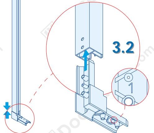
**4** Inserire le guide, sia superiore che inferiore, nelle squadrette ad angolo del profilo laterale sinistro montato in precedenza.
