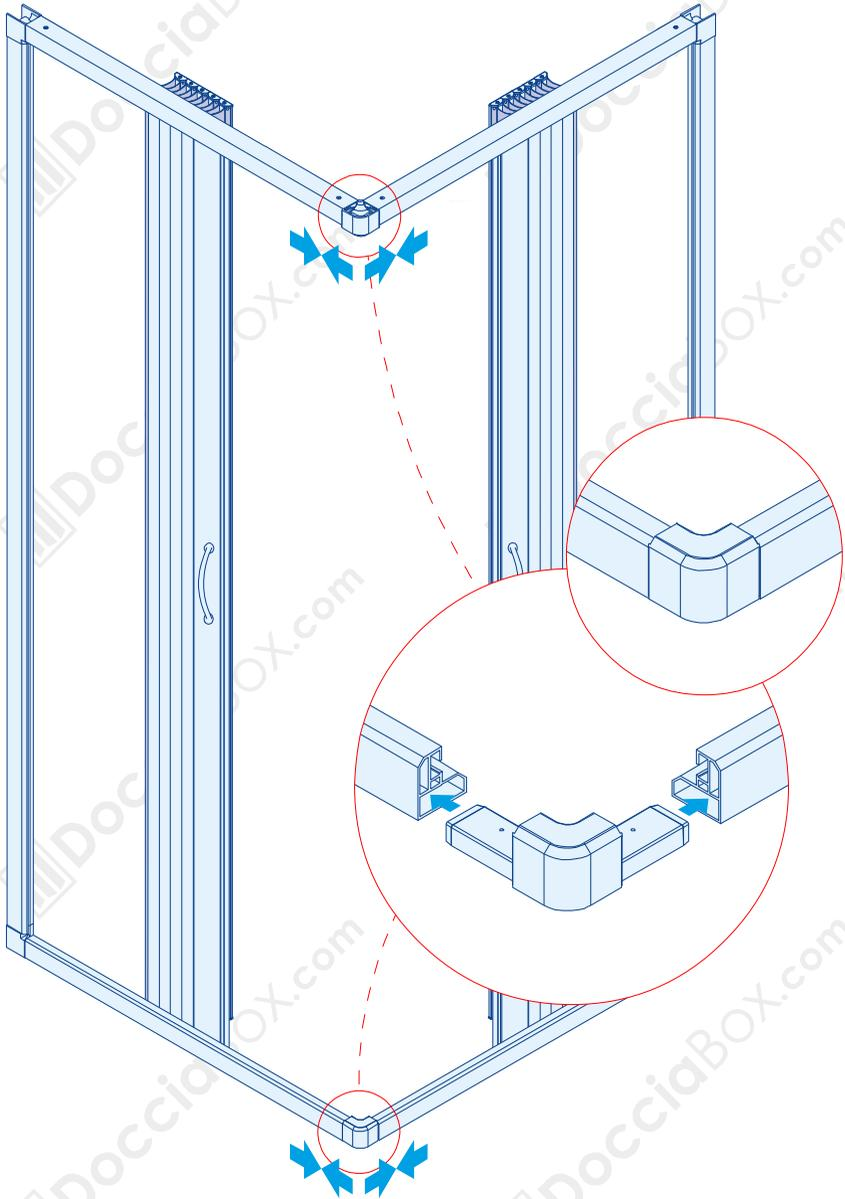
**9** Appoggiare il **box assemblato** sul piatto e addossarlo alle pareti, come in figura. Segnare sulle pareti con un punteruolo, attraverso i **dieci** fori presenti sui profili, la predisposizione per il successivo fissaggio (Fig. 9.1).
