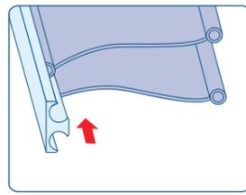
Unire in coppia le ante trasparenti tramite l'infibole dell'apposita cerniera
