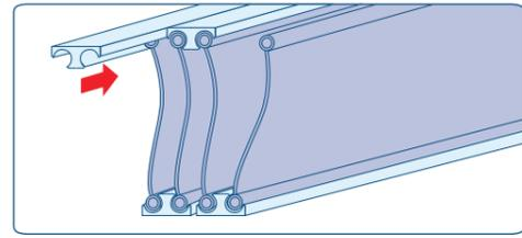
Posizionare su un piano orizzontale le coppie preassemblate ed unirle tra loro tramite l'infibole delle altre cerniere
