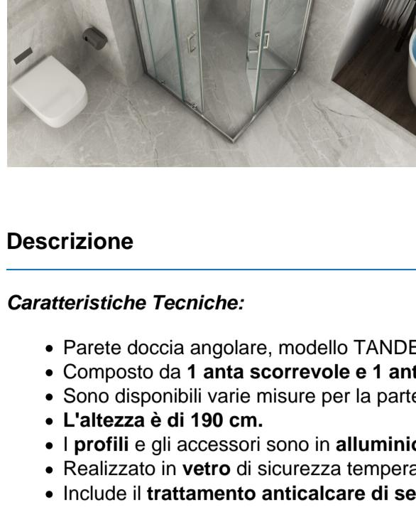
Box doccia trasparente a 2 lati con porta doccia scorrevole frameless 6 MM piu' apertura combinata a libro (pieghevole) e battente. Telaio in alluminio cromo lucido. H 190cm. Anticalcare incluso.
