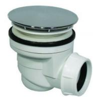
Piletta in PVC per piatti doccia con foro da 60 mm. Piattello in ABS cromato di diametro 120 mm. Diametro uscita da 40 mm. Comprensa di dado e guarnizione per innesto.
