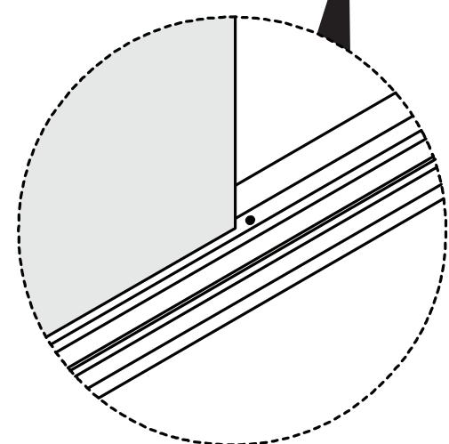
Le guide sono inserite correttamente se il fori presente nella parte centrale delle guide si trova in corrispondenza della fine del vetro.
