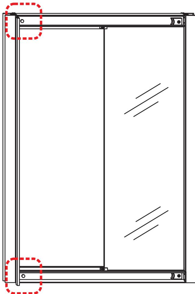
Prima di avvitare le viti che bloccano il profilo laterale calamitato alle guide orizzontali, inserire la rondella bianca in dotazione. Questa serve a mantenere il tappino coprivite ed inoltre impedisce che la vite (apparentemente lunga) deformi il profilo (la guida).
